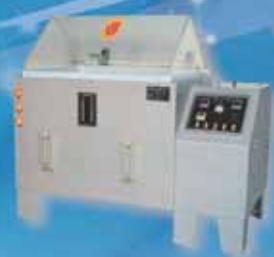
■ 鹽水噴霧試驗機電度層 的鹽霧測試機
