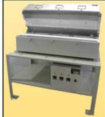
1150°C 三區長晶爐, CVD 系統
