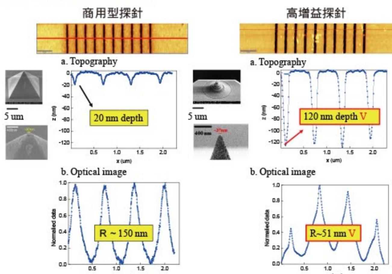
在表面形貌的表現上，高效益光學探針可探測到較深的實際深度，達到較高的空間解析度。在光場表現上，可偵測到較為細微的光強場效應。
