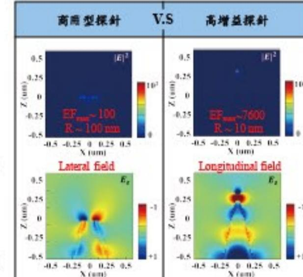
已商業化穩定製程的圓錐形探針曲面尺寸，設計製造出電漿子優化探針。
