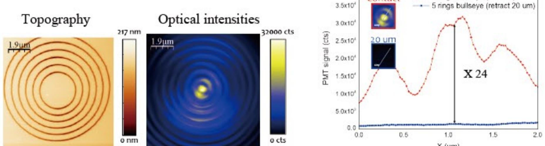
高效益光學探針的強場集中效應，使得訊雜比可達24倍，遠高於現有發表過的無孔隙式近場光學顯微技術的量測(1~10倍)結果。
